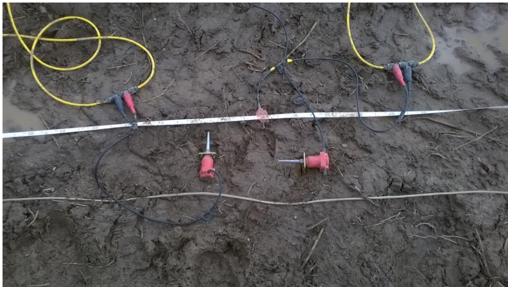
Posizionamento dei sensori per misurazioni con tecnica microtremori HVSR
